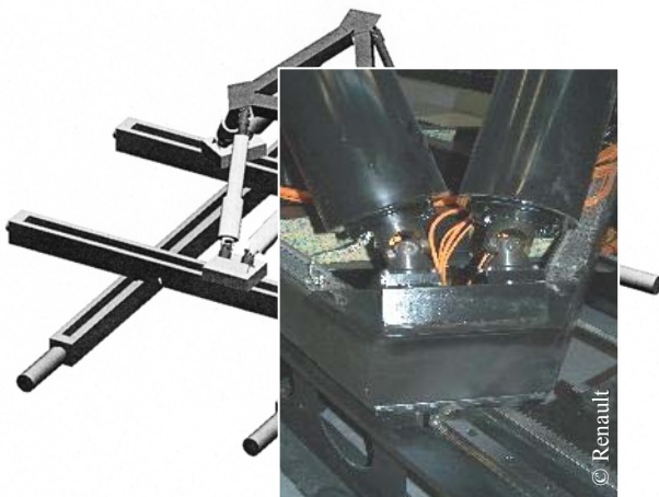
Systèmes de mouvements linéaires X-Y & 6 DOF pour ULTIMATE
