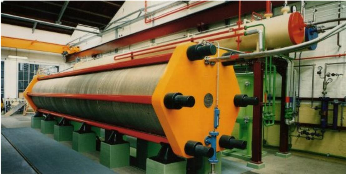
**Figure 11 – Electrolyseur alcalin ELT type S 556, 760 Nm<sup>3</sup>/h – 30 bars**
