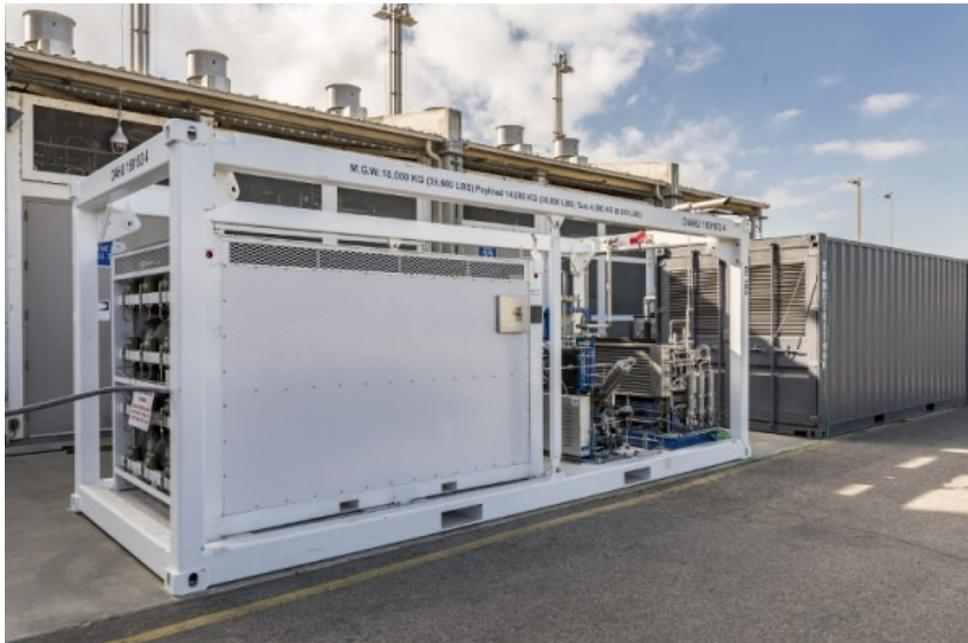
Figure 7 – le système réversible SOEC/SOFC de Boeing (2016)
