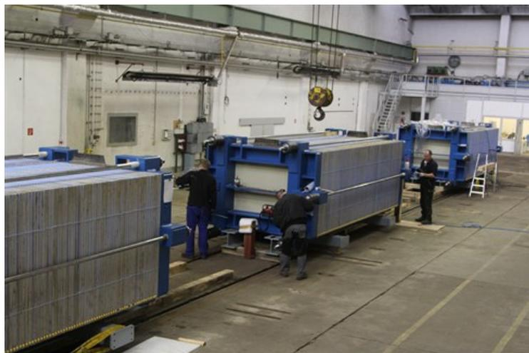
**Figure 3 – Trois unités d'électrolyseur alcalin Enertrag de 2 MW unitaire – 1000 m<sup>3</sup>/h**
