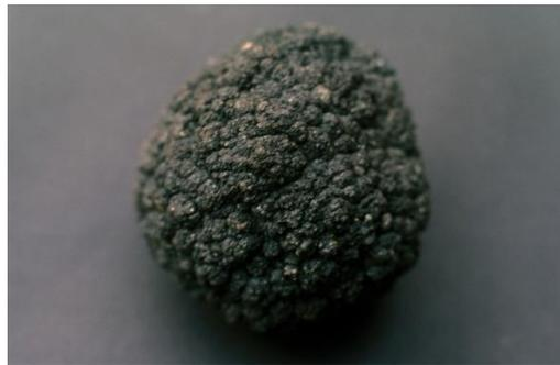
Figure 2 Un nodule polymétallique (diamètre entre 5 et 20 cm) (Source : © KOELLE, WIKIMEDIA COMMONS, CC BY-SA 3.0)
